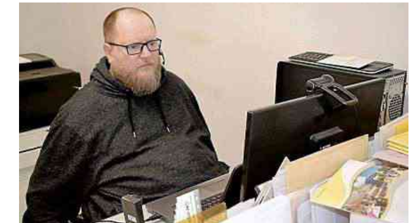
Steffen Kage an seinem Arbeitsplatz: Am Ohr hat er ein Headset, eine Kamera über dem Bildschirm beobachtet seine Augen. So kann er seinen Computer steuern.
