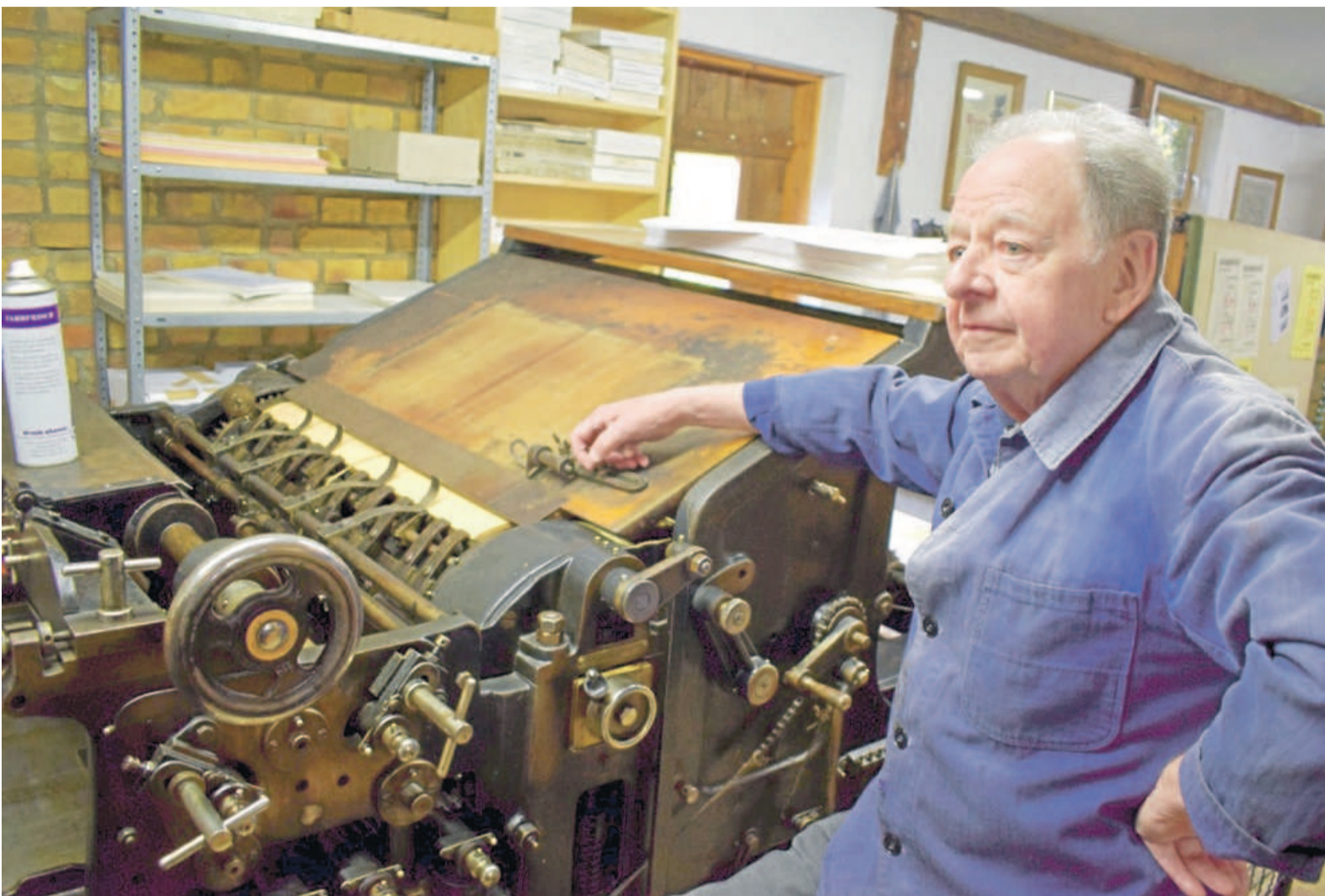
Toni Baumann, der Drucker-Fachmann, vor der mächtigen Stoppzylinder-Schnellpresse. Fotos: Moeller
