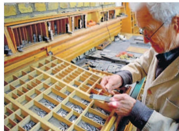
Hermann Schmelz, der Schriftsetzer, setzt die Worte zusammen – Bleibuchstabe für Bleibuchstabe.
